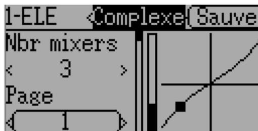
Un appui long sur la touche 'ENT' permet d'enregistrer rapidement la configuration du mixer et de le tester sur la radio.
