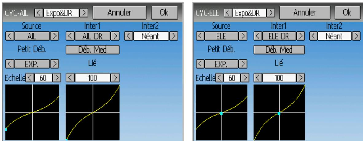
Les écrans de la page précédente montrent les réglages pour Aileron et Profondeur (l'anti-couple n'est pas montré). Les réglages sont quasiment identiques sur les 3 canaux (seuls sources et interrupteurs diffèrent).
