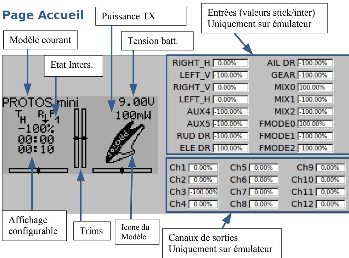
**Modèle courant:** Nom du modèle RC en cours d'utilisation. Sa configuration se fait depuis la page de configurations des Modèles ('Config. Modèle').
