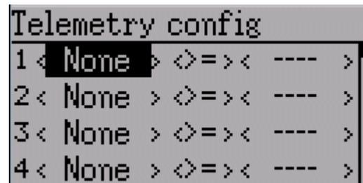
**Télémétrie:** Désigne les entrées de télémétrie contrôlant l'alarme. On peut utiliser les sondes de température (T°), de Tension (Volt) ou de Régime moteur (T/mn).
