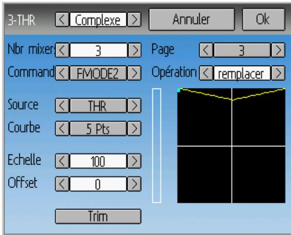
On va maintenant configurer l'interrupteur de sécurité Throttle-Cut (RUD/DR par exemple) sur l'entrée des Gaz (3-THR) et régler la valeur de sécurité à -100.
